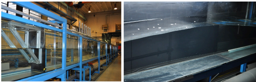
Figura 1. Imagen general del canal de oleaje (izquierda) y de la zona de medida (derecha).
