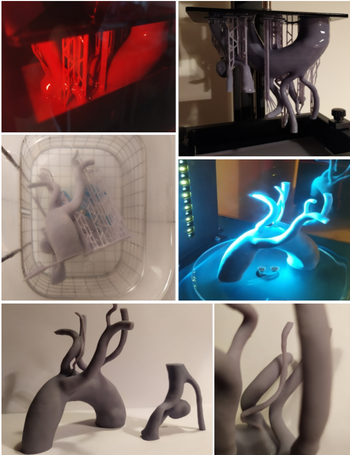
Figura 9. Proceso de impresión 3D (tecnología MSLA) del modelo de aorta. a) Impresión en proceso; b) Final del proceso de impresión; c) Lavado de la pieza; d) Curado de la pieza, previa eliminación de los soportes, en equipo con base rotatoria; e) Modelo físico de aorta resultante del proceso de impresión MSLA. f) Detalle de un vaso sanguíneo de menos de 2 mm de diámetro.
