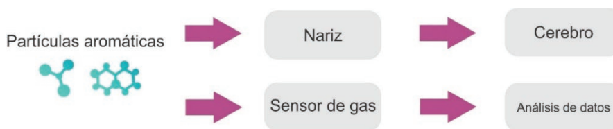
Figura 1. Analogía entre el sistema olfativo biológico y la tecnología de la nariz electrónica. Adaptado de [1].
