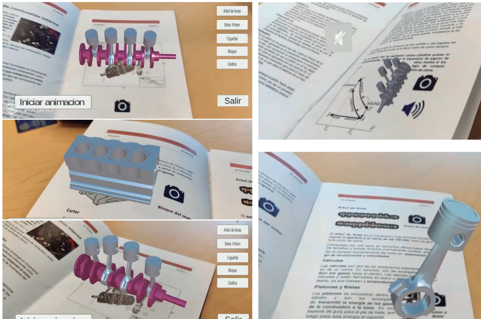
Figura 6. Fotografías del uso de la aplicación en RA del motor de combustión de cuatro tiempos y su manual
