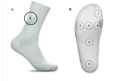
Figura 3. (A) Bateria, controlador i xip Bluetooth (B) Planta del mitjà amb la col·locació dels sensors (Reyzelman et al., 2018)
