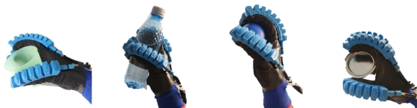
Figura 2. Pruebas de uso del dispositivo experimental en relación de uso con objetos de distintas geometrías. Fuente: Biris et al., 2023.
