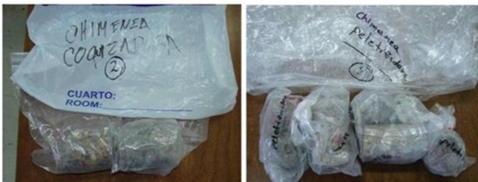
Figura 9. Testigos (corazones de concreto) extraídos de las chimeneas
