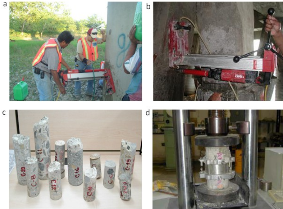
Figura 2. a) b) y c) Muestran la extracción de núcleos y d) el ensayo mecánico
