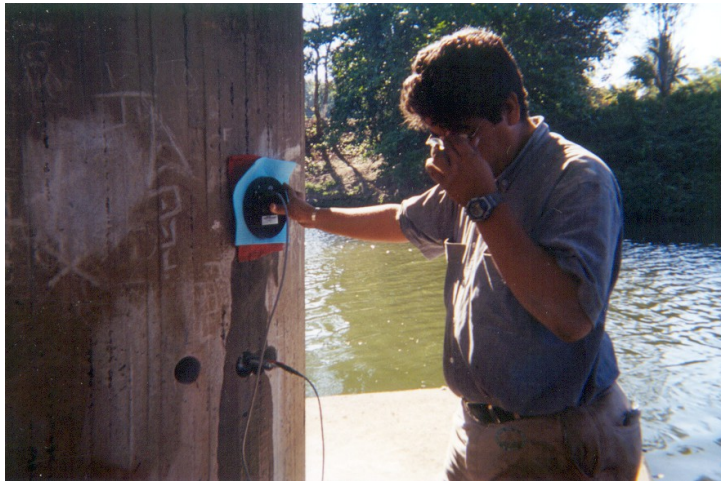
Figura 8. Muestra la medición de intensidad de corrosión
