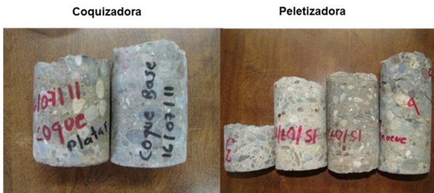
Figura 10. Testigos (corazones de concreto) para Carbonatación
