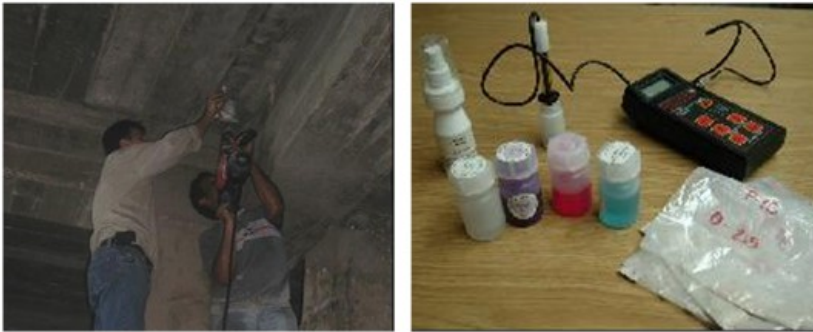
Figura 6. Extracción de muestras y equipo para análisis de cloruros
