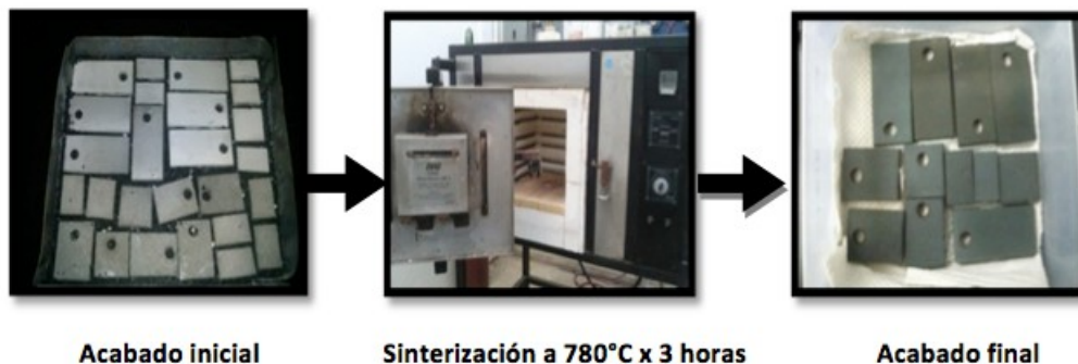
Figura 30. Proceso de Sinterizados de los recubrimientos
