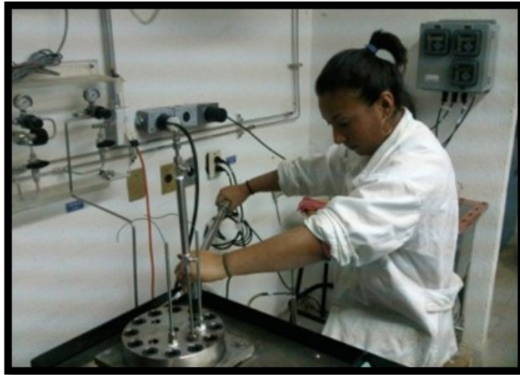
Figura 42. Apriete de los tornillos de la tapa de la autoclave con torquímetro
