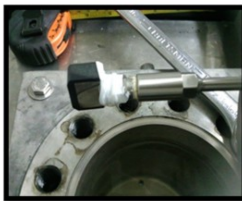
Figura 41. A) Apriete de los electrodos, B) Electrodo trabajo con aislamiento de teflón
