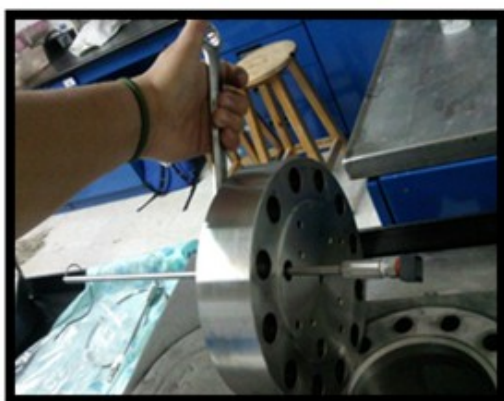
Figura 41. A) Apriete de los electrodos, B) Electrodo trabajo con aislamiento de teflón
