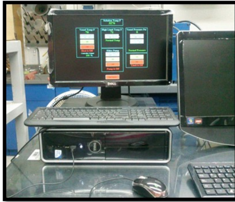
Figura 44. Sistema de cómputo con software para controlar la Autoclave
