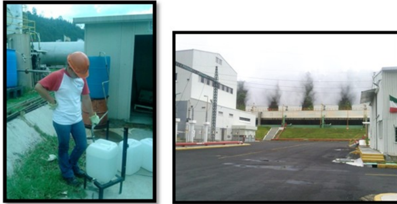
Figura 27. Recolección de fluido geotérmico del pozo AZ-7 en Los Azufres
