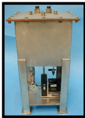
Figura 39. A) Recipiente para recircular el electrolito y B) configuración de los 3 sensores de conductividad, oxígeno y pH
