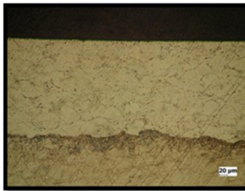
Figura 60. Metalografías de MCrAlY; A) Estado inicial antes de sinterizar y B) Post tratamiento térmico
