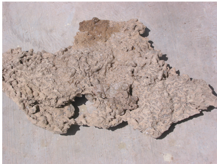
Figura 7. Muestra de una formación mineral de incrustación típica de Cerro Prieto
