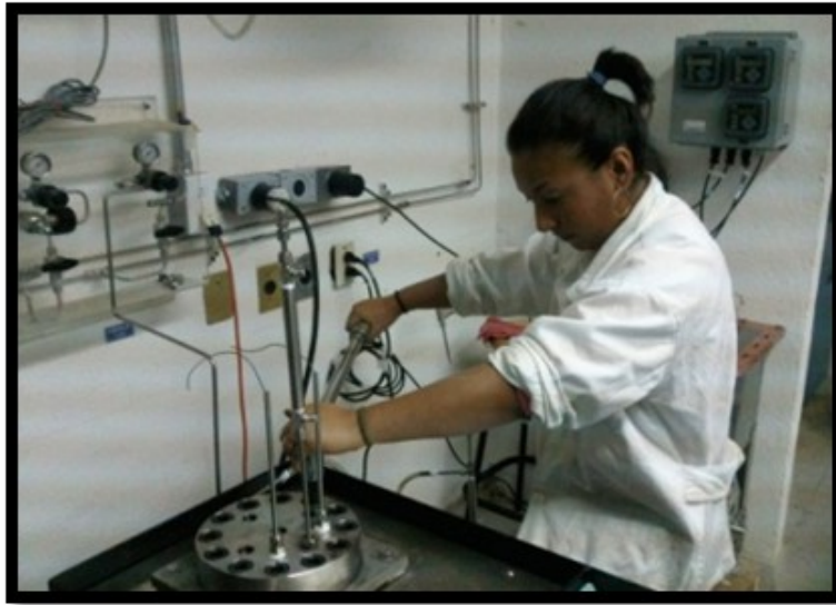
Figura 42. Apriete de los tornillos de la tapa de la autoclave con torquímetro
