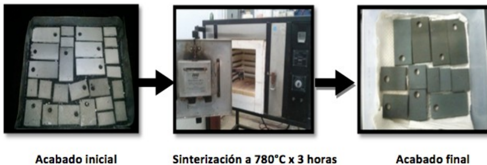
Figura 30. Proceso de Sinterizados de los recubrimientos
