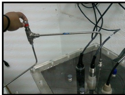
Figura 45. Válvula de alivio para regular la presión del sistema de autoclave
