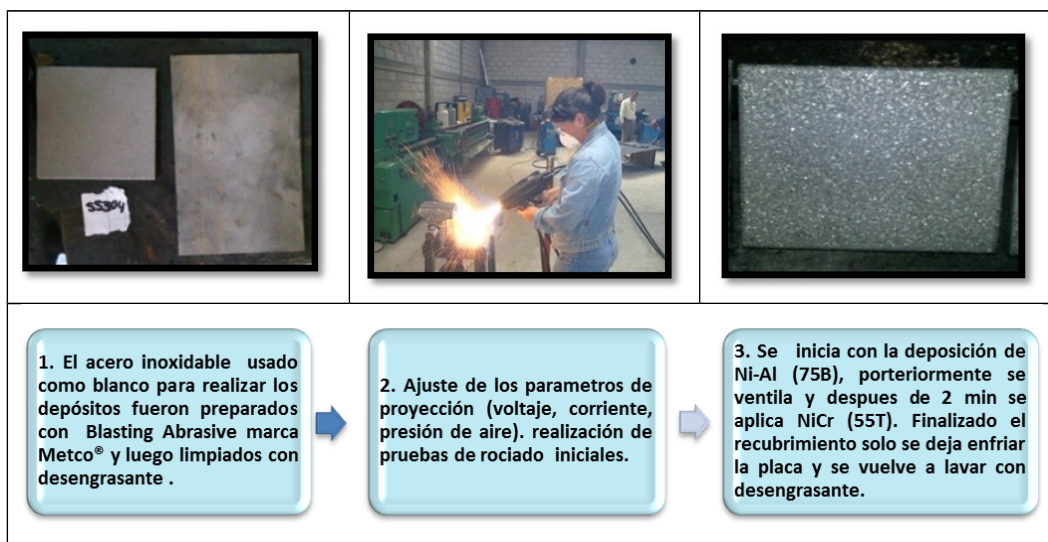
Figura 20. Proceso de elaboración de los recubrimientos por Arco Eléctrico
