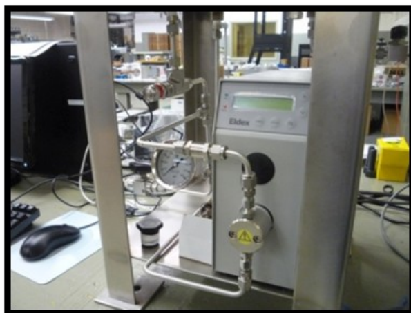
Figura 40. Bomba dosificadora Marca OPTOS
