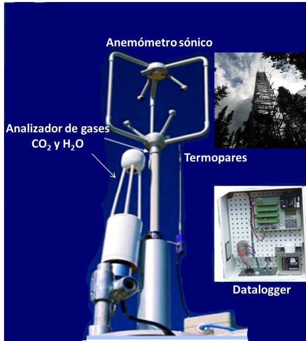
Figura 8. Instrumentación típica de un sistema eddy covariance. El anemómetro sónico, el analizador de gases (sistema abierto y cerrado) y otros accesorios como los termopares. La elección de los diferentes tipos de accesorios depende de las necesidades del usuario. Burba y Anderson (2010)
