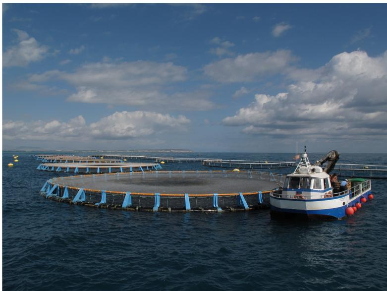
Foto 5. Embarcación de servicio de la piscifactoría alimentando una jaula mediante cañón de aire
