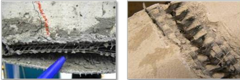
Figura 4.11: Despegue prematuro (izquierda) y rotura tejido carbono (derecha).
