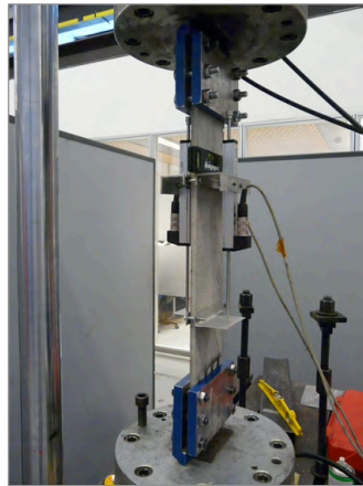
Figura 4.7: Perspectiva general del ensayo de tracción axial del TRM.
