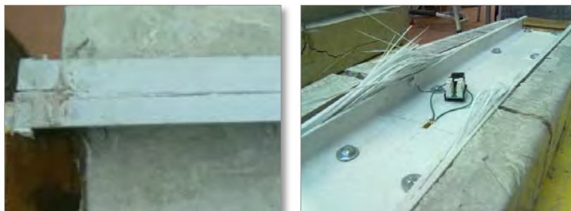
Figura 9.8: Fallo de HB-1 (izquierda) y HB-3 (derecha) debido a concentración de tensiones cortantes y a la rotura por tensión de las fibras, respectivamente.
