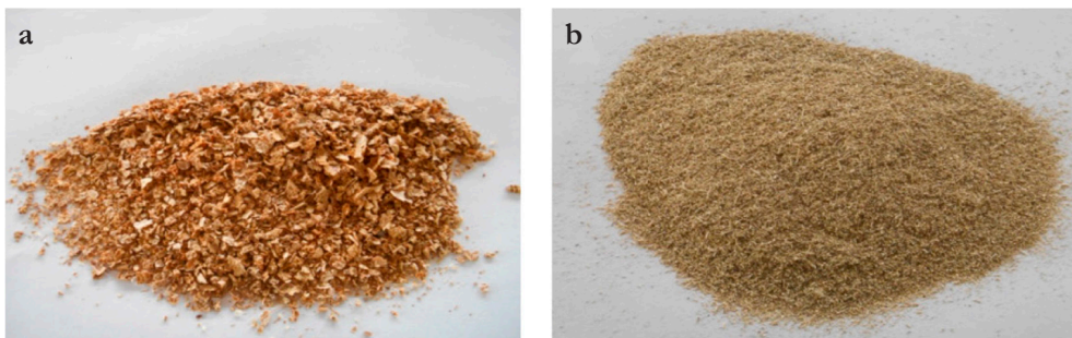
Figura 4. Fibra de cáscara de cacahuete (a) y de alcachofa (b) extraídas por el método químico alcalino.
