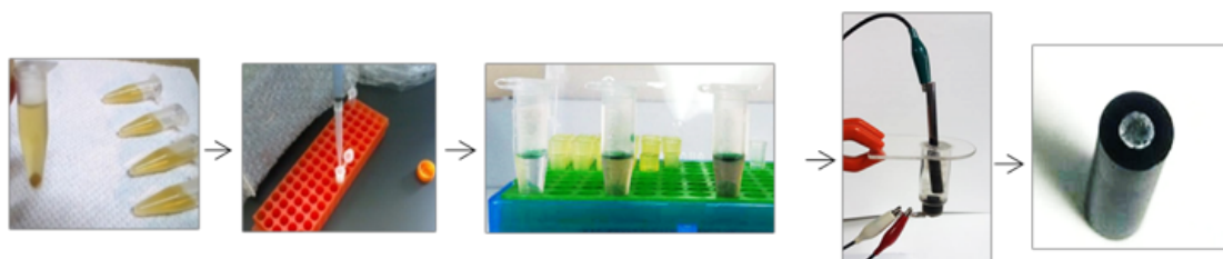
Figura 1. Esquema de modificación del electrodo por electrodeposición
