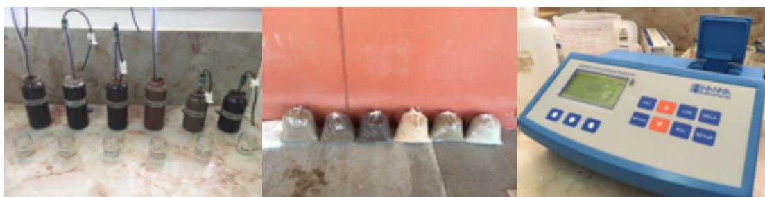
Figura 1. Toma de muestras y medición de formas inorgánicas de N, P, K con espectrofotómetro
